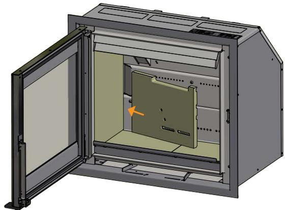
Die rechte Brennkammerplatte montieren
