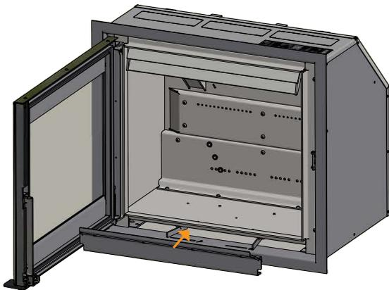
Die Bodenplatten so einsetzen, dass die abgeschrägte Kante nach hinten und abwärts kehrt.
