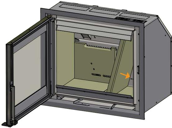
Die rechte Rückplatte montieren. Die hinteren Brennkammerplatten müssen so montiert werden, dass die Öffnungen in den Platten exakt über den Tertiäröffnungen des Einsatzes sitzen
