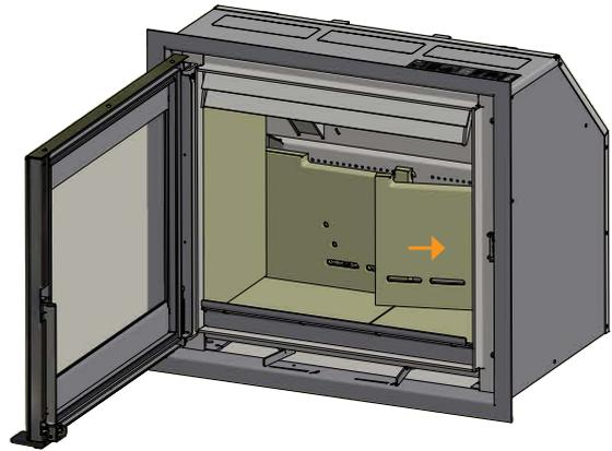
Die untere Rauchumlenkplatte montieren. Die Rauchumlenkplatte muss von den Rückplatten gestützt werden. Die Stifte montieren und die Rauchumlenkplatte einsetzen
