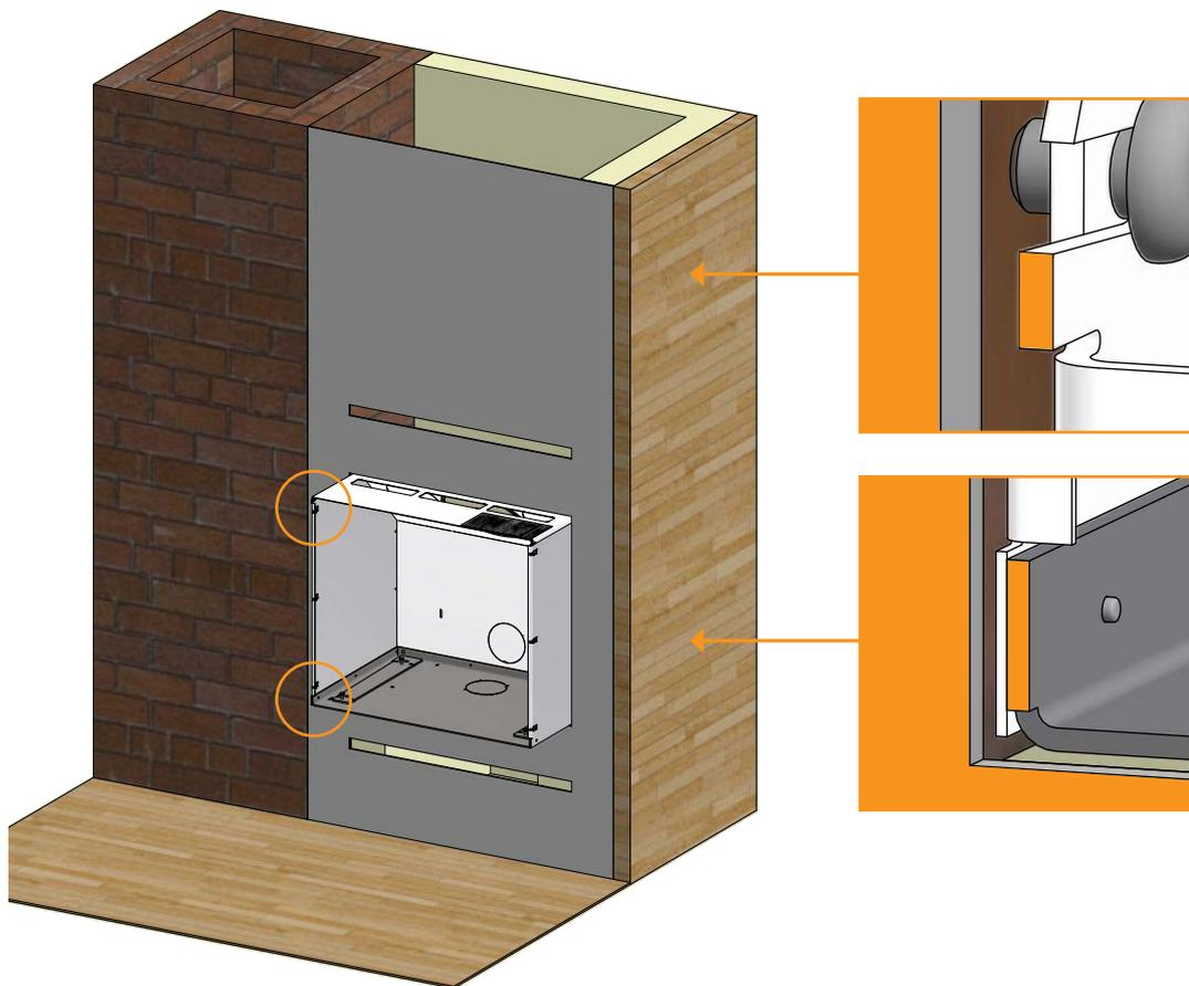
Die Einstellpunkte in den vier Ecken der Kassette müssen bündig zur Vorderseite der Umrahmung sein
