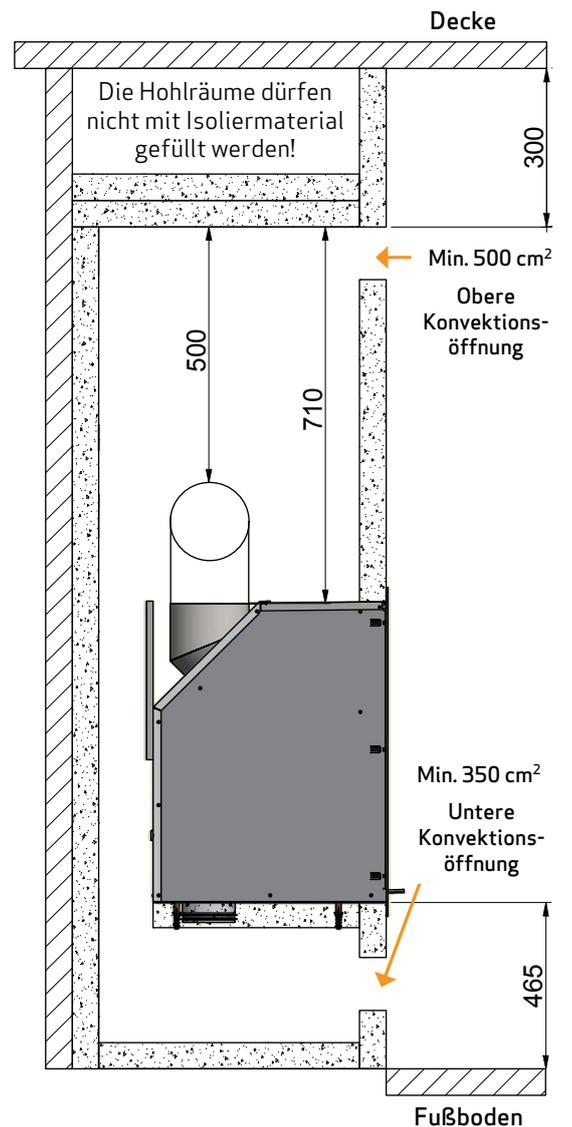
**Aufstellung mit isoliertem, senkrechtem Rauchrohr**
