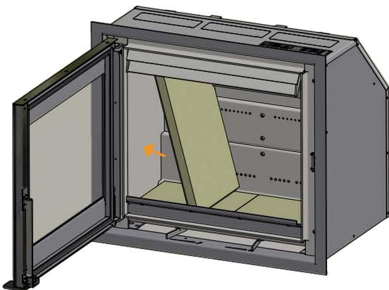
Die linke Rückplatte montieren
