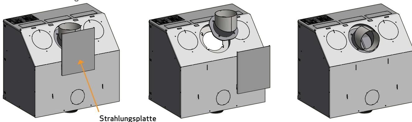
Die Dichtung (3 x 8 mm) auf der Kante des Anschlussstutzenflanschs anbringen.
