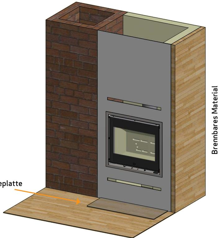
Diese Abdeckplatten müssen beim Einbau in brennbarem Material mit Isolierung entfernt werden
