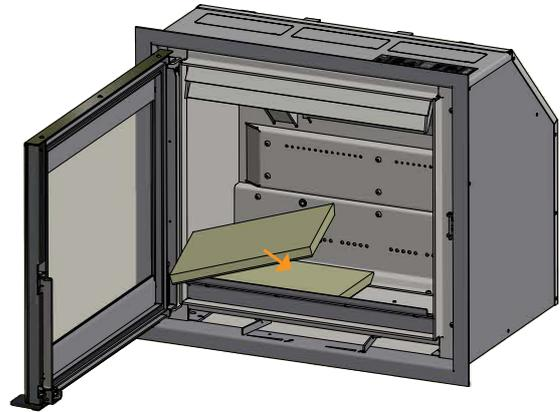
Die linke Brennkommerplatte montieren
