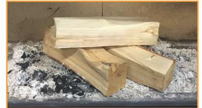
Bei der EN 13229-Prüfung wurde der Ofen wie auf dem Bild gefeuert:
